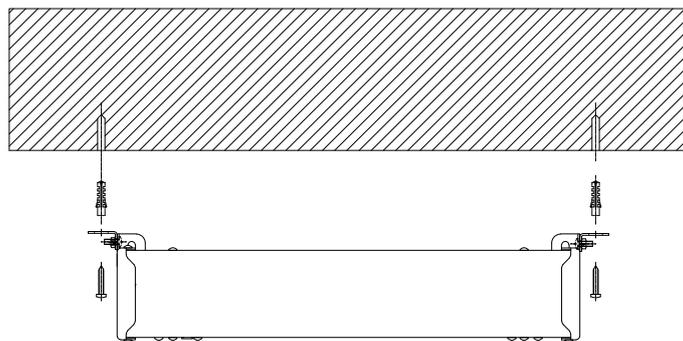
步骤四、用锤子将 $\phi 8$ 胶粒敲入8个孔中（胶粒无塑料部分露在外面），M6自攻螺丝穿过产品顶装板安装孔拧入胶粒中。
