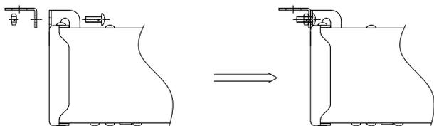
步骤一、产品的两端将顶装板用M6x16螺钉与M6防滑螺母安装在产品上（如上图）
