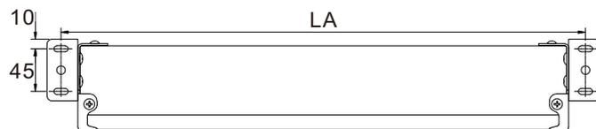
步骤二、测量产品两端顶装板上两长圆孔距离，根据测量的数据在需要安装投影幕的位置进行画线。
