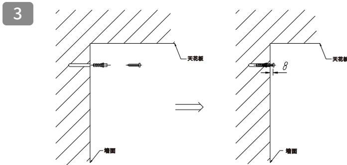
步骤三、用锤子将φ8胶粒敲入8个孔中(胶粒无塑料部分露在外面), M6自攻螺丝拧入φ8mm胶粒中, M6螺丝预留8mm长度在外面(如上图所示)。
