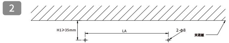
步骤一、根据测量距离LA, 在需要安装投影幕的墙壁位置进行划线并用电钻(电锤)钻2个φ8mm孔(如上图), 孔深度40-60mm左右, 注意φ8mm孔中心点到天花板距离H1必须≥35mm(两孔必须在一个水平面上)
