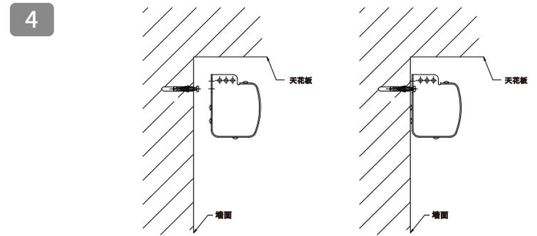
步骤四、将产品挂在螺丝上(如上图), 拧紧M5螺丝, 安装完成。
