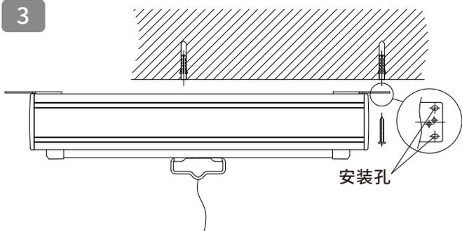
步骤三、将塑料胶粒敲入φ8孔中(塑胶件不突出天花平面), 把产品两端顶装板移动至靠紧产品塑料端盖(如上图所示), 将两颗M6螺丝穿过安装孔, 拧入塑料胶粒中。
