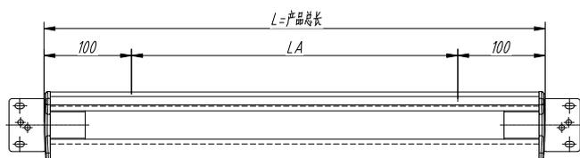
步骤一、测量产品总长度L,计算出两个安装挂板安装距离LA
