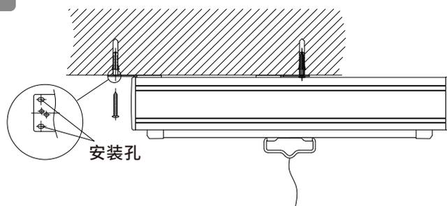
步骤四、平行移动产品将另一安装方向安装孔对齐胶粒(如上图所示), 拧入M6螺丝。
